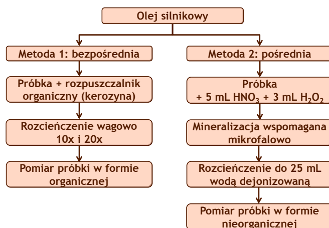
Rys. 2. Schemat blokowy metod przygotowania próbki do pomiaru
