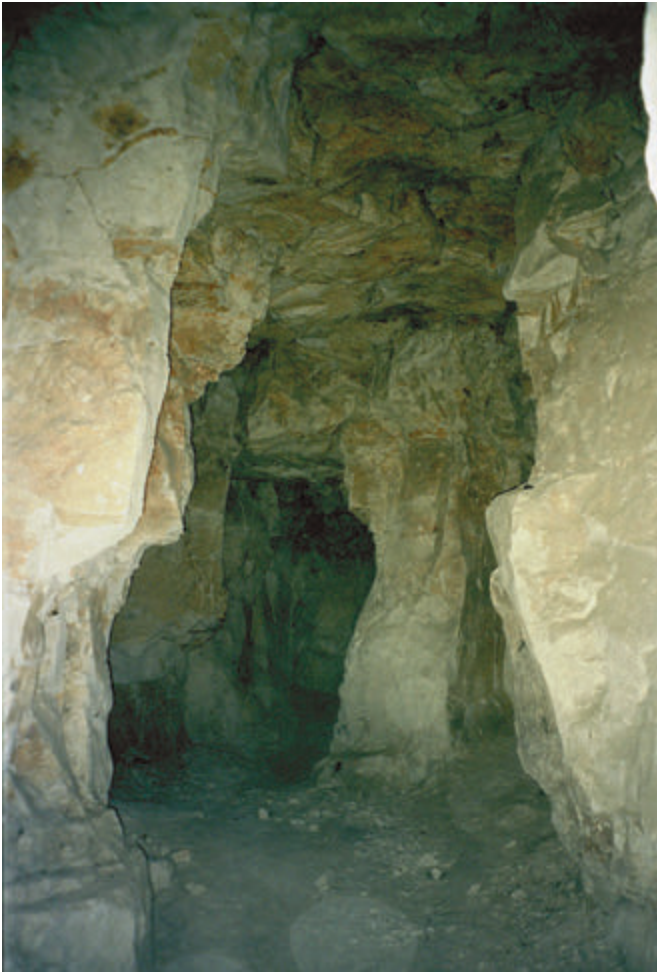
Fot. 5. Komorowa eksploatacja opok w Bochothnicy Fot. 5. The chamber exploitation of opoka in the Bochothnica quarry
