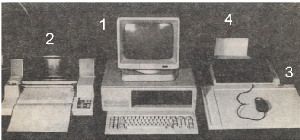
Rys.5. Konfiguracja składająca się z komputera (1), plotera (2), tabletu (3) i drukarki (4) [11]
