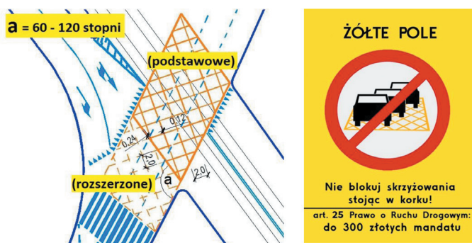
Rys. 8. Wariant W1 – propozycja oznakowania poziomego (lewa część rysunku) dla oznaczenia żółtych pól w Krakowie na przykładzie skrzyżowania ul. Królewskiej z Aleją Trzech Wieszczów. Wymiary podano w [m].
