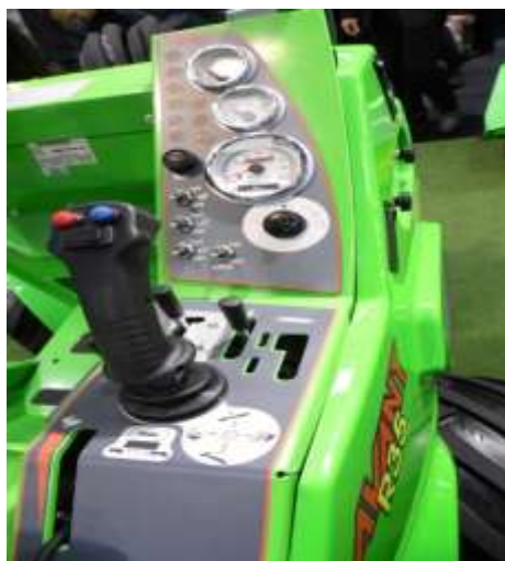
Rys. 3. Układ sterowania wymiennymi narzędziami nośnika AVANT R35. (zdjęcie autora, Agritechnica 2013, Hannover)
