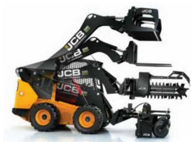
Rys. 5. Kompaktowy nośnik narzędzi JCB. ( www.jcbvision.com/data/en/assets/files/brochures/JCB_Skid_Steer_Loader_Range_Brochure.pdf )
