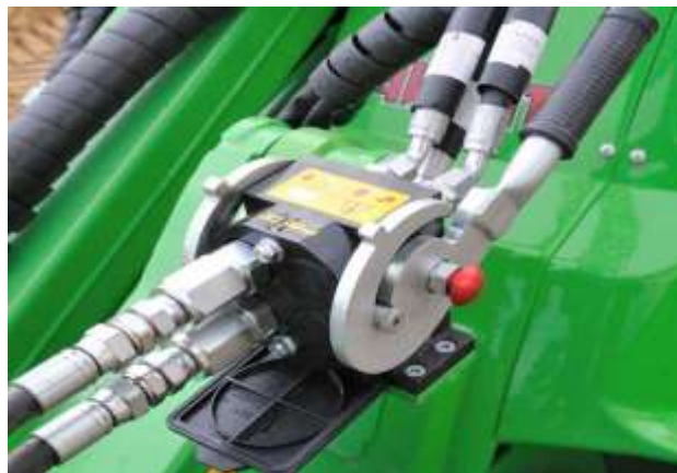
Rys. 2. Wielozłącze jako standardowe wyposażenie w nośnikach narzędzi AVANT. (www.avantteco.com)
