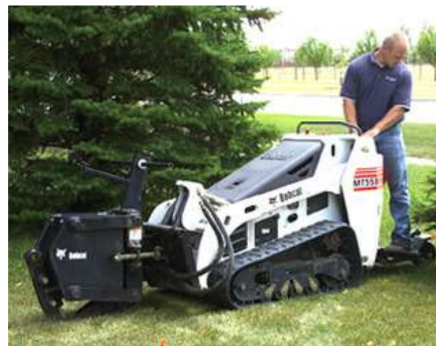
Rys. 6. Gąsienicowy nośnik narzędzi MT55. ( www.bobcat.com )
