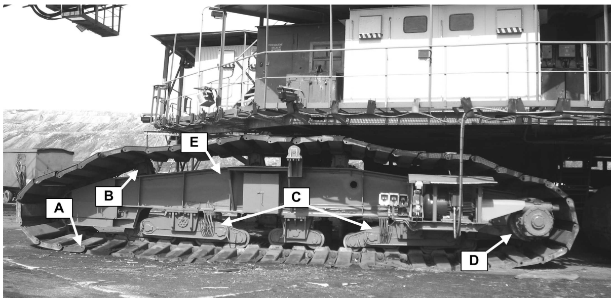
Rys. 1. Podstawowe podzespoły wielkogabarytowego podwozia gąsienicowego: A – łańcuch gąsienicowy, B - koła wsporcze, C – układy wahaczowe, D – wielobok napędowy, E – dźwigar gąsienicy Fig. 1. Basic subassemblies of a large-size tracked undercarriage: A – caterpillar chain, B – supporting wheels, C – balance lever's units, D – driving wheel, E – caterpillar's girder
