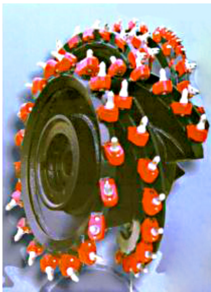
Rys. 7. Frezujące organy ślimakowe wyposażone w: a) noże styczno-obrotowe, b) narzędzia dyskowe (fot. autorska)
