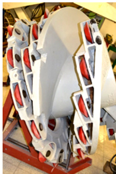
Rys. 7. Frezujące organy ślimakowe wyposażone w: a) noże styczno-obrotowe, b) narzędzia dyskowe (fot. autorska)
