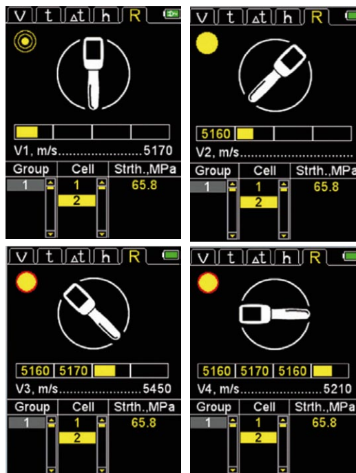
Rys. 6. Przykład pomiaru wytrzymałości przy 4 położeniach urządzenia
