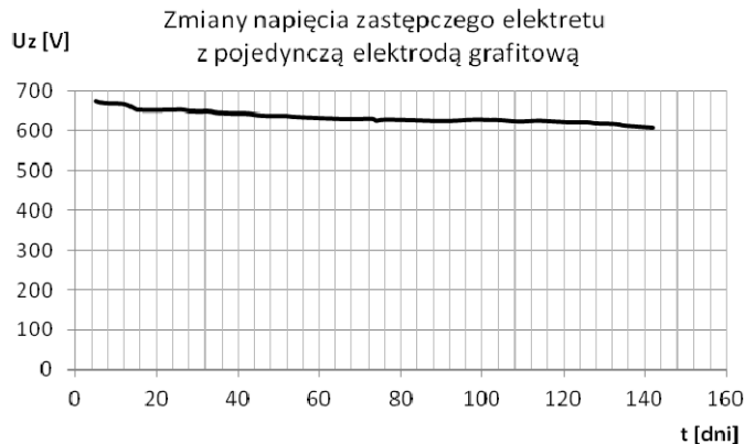
Rys. 5. Zmiany napięcia zastępczego elektretu w temperaturze otoczenia
