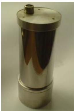
Rys. 6. Czujnik promieniowania jonizującego z komorą elektretową
