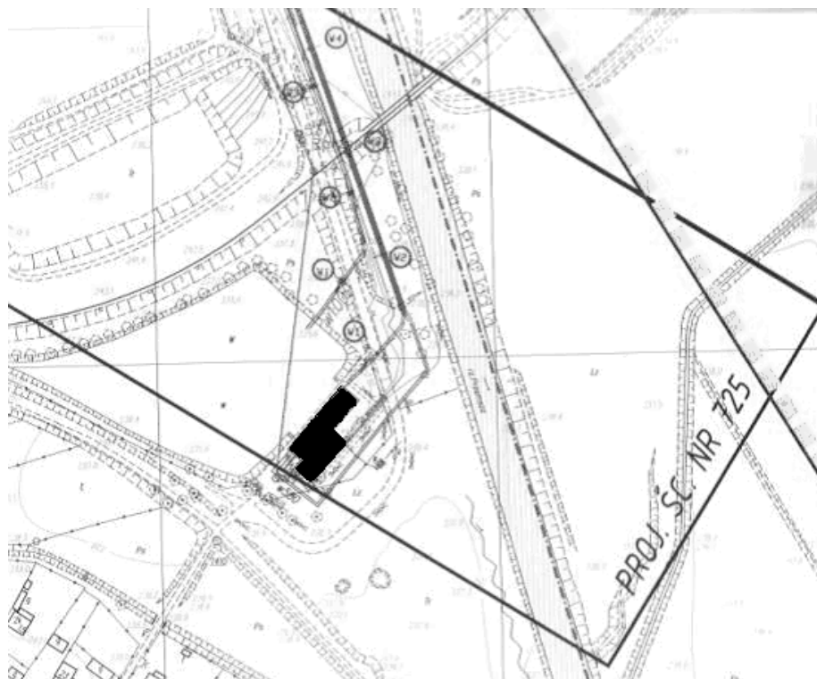
Rys. 2. Usytuowanie obserwowanego obiektu na tle eksploatowanej ściany
