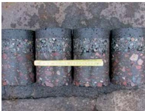
Rys. 22. Odwierty pobrane z nawierzchni do badań kontrolnych – u góry widoczna cienka warstwa PMA 5
