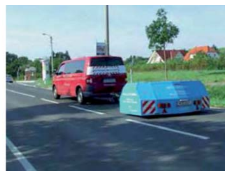
Rys. 12. Pomiar emisji hałasu nawierzchni Stotternheimer Strasse urządzeniem firmy BBM Müller
