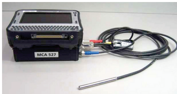
Rys. 2. Miniaturowy wielokanałowy analizator z detektorem CdZnTe i mini komputerem (Miniature multichannel analyser with CdZnTe detector – MMCC) (IAEA)
