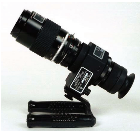
Fot. 4. Pomiar wypalonego paliwa detektor promieniowania Czerenkowa Photo 4. Improved Cerenkov viewing device – ICVD for irradiated fuel verification (IAEA)
