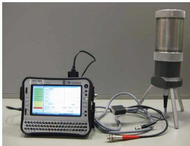
Fot. 1. Miniaturowy wielokanałowy analizator z detektorem NaI i mini komputerem
