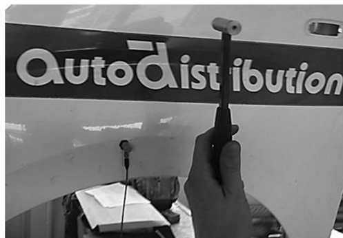
Rys. 3. Przykład eksperymentu analizy modalnej Fig. 3. Example of modal analysis research
