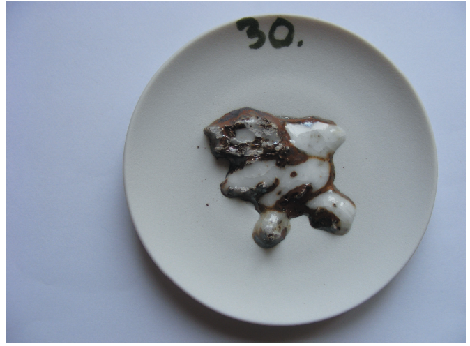
Fot. 4 Wypał ziaren skalenia z gnejsu grubo- laminowanego w temp. 1385^\circ\text{C} Fot. 4. Calcination of feldspar grains from thick-laminated gneiss in a temperature of 1385^\circ\text{C}
