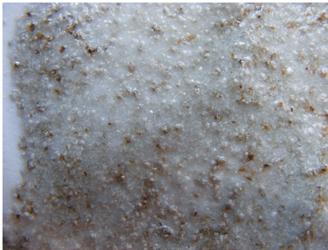
Fot. 7. Produkt końcowy 7D/11 (0,2-0,8 mm) wypał w temp. 1385°C Fot. 7. End product 7D/11 (0.2-0.8 mm) calcination in the temperature of 1385°C
