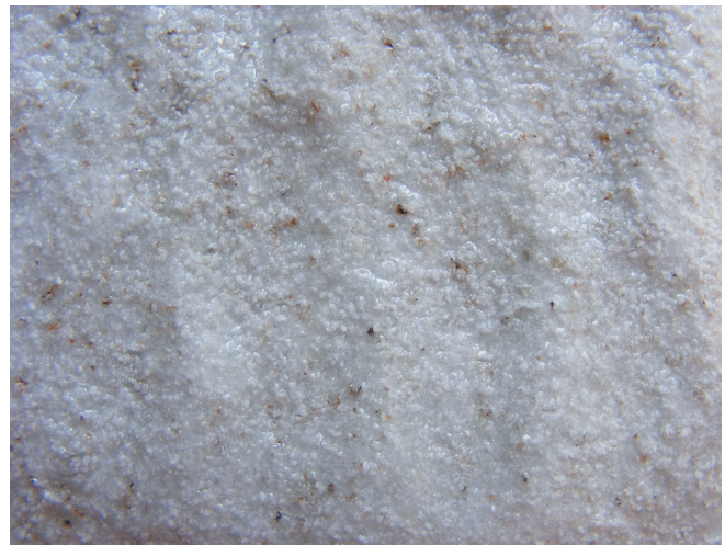
Fot. 10. Produkt końcowy 76 B/08 (0,2-0,8 mm) -wypał w temp. 1385°C Fot. 10. End product 76B/08 (0.2-0.8 mm)- calcination in the temperature of 1385°C
