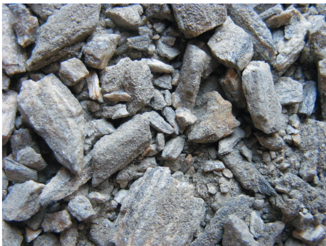
Fot. 3. Gnejs – frakcja odpadowa (0-11 mm) próbka 77 – powiększenie 2,5x Fot. 3. Gneiss-waste fraction (0-11 mm) sample 77-magnification
