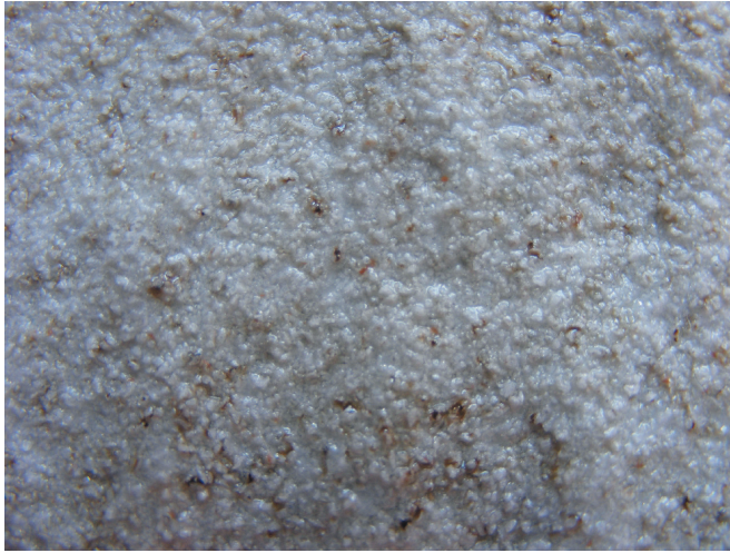
Fot. 9. Produkt końcowy 77A/08 (0,2-0,8 mm) -wypał w temp. 1385°C Fot. 9. End product 77A/08 (0.2-0.8 mm)- calcination in the temperature of 1385°C
