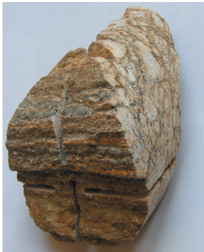
Fot. 1. Gnejs laminowany oczkowy-rdzeń z otworu 7D/11-12 m Fot. 1. Laminated augen gneisses- core from 70/ 11-12 m hole
