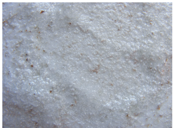
Fot. 8. Produkt końcowy 7D/40 (0,2-0,8 mm) wypał w temp. 1385°C Fot. 8. End product 7D/40 (0.2-0.8 mm) calcination in the temperature of 1385°C
