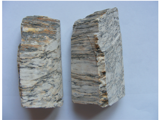
Fot. 2. Gnejs laminowany pasiasty-rdzeń z otworu 7D/27-28 m Fot. 2. Laminated striped gneisses- core from 70/27-28 m hole
