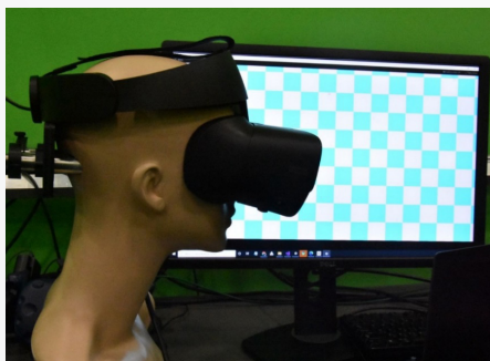
Rys. 1. Gogle VR Oculus Rift podczas pomiarów wraz z podglądem wyświetlanego obrazu na ekranie monitora
