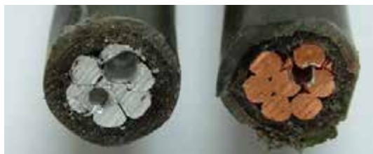
Ryc. 5. Zestaw 3 – kable z żyłami z aluminium i miedzi
