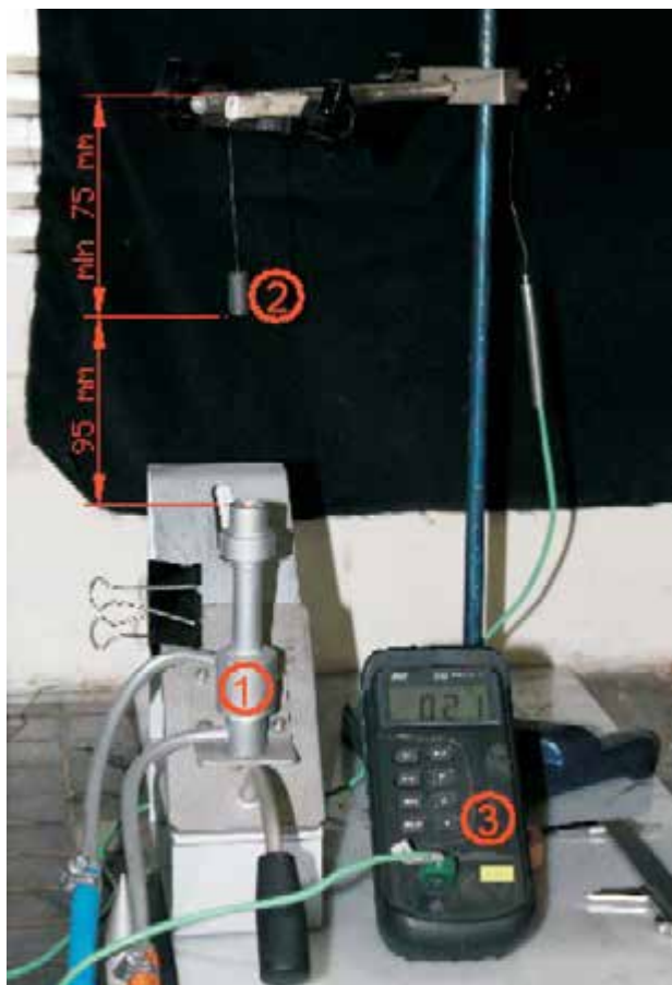
Ryc. 2. Układ do próby sprawdzającej wg PN-EN 60695-11-2 (1 – palnik, 2 – blok miedziany z termoparą, 3 – urządzenie do wskazywania temperatury i czasu)
