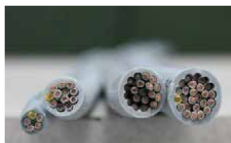
Ryc. 3. Zestaw 1 – kable nieekranowane
