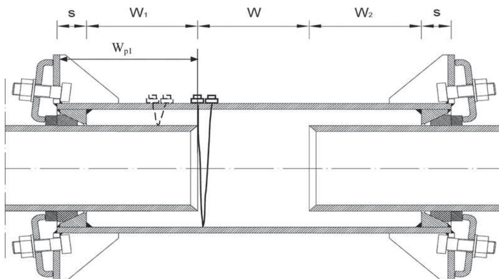
Rys. 1. Zasada pomiaru położenia końców rur w kompensatorze z zastosowaniem defektoskopu ultradźwiękowego
