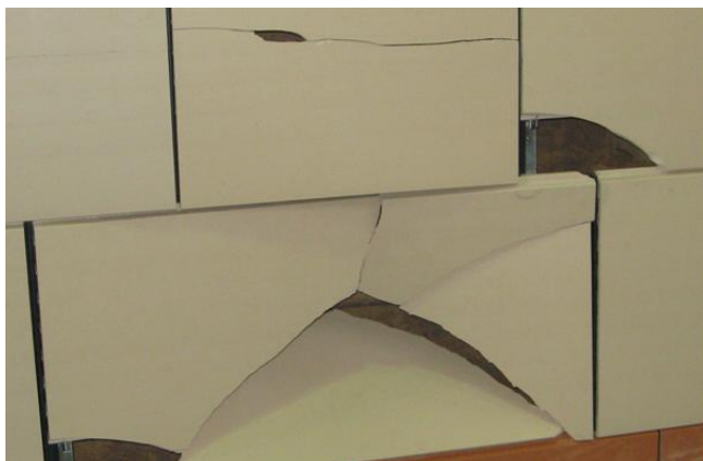
Fot. 3. Skutki uderzenia ciałem miękkim i ciężkim (o masie 50kg z energią 400 J) elewacji o klasie odporności na uderzenie poniżej I
