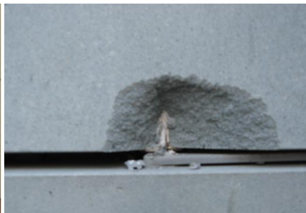
Fot. 3. Skutki uderzenia ciałem miękkim i ciężkim (o masie 50kg z energią 400 J) elewacji o klasie odporności na uderzenie poniżej I
