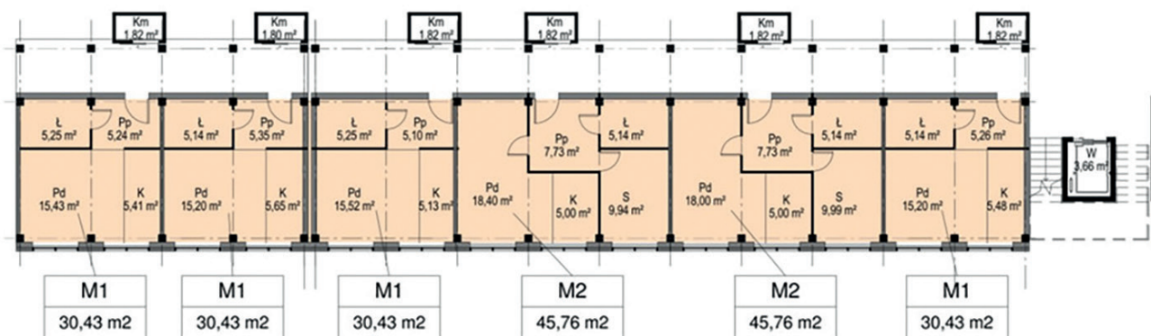
Rys. 4. Przykładowy rzut budynku z konkursu osiedla Forsycji TBS w Stargardzie; źródło: autor
