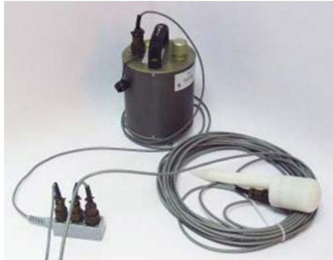
Rys. 3. Sejsmometr CMG-6TD firmy Güralp Systems Ltd ( www.guralp.com )
