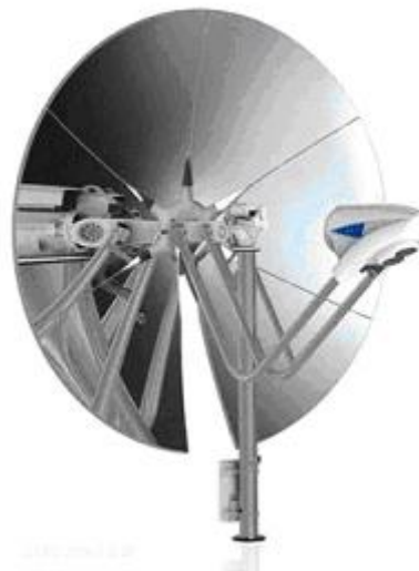
Rys. 3.9. Generator prądu PowerDish zasilany energią słoneczną, sprawność el. 24%, średnica zwierciadła parabolicznego 4,7 m, w ogniskowej zwierciadła umieszczono silnik Stirlinga z generatorem prądu [6]
