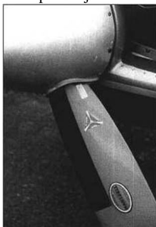
Rys.7. Elektryczna instalacja przeciwooblodzeniowa łopat śmigła. [6]
