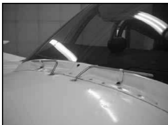
Rys. 9. Instalacja przeciwooblodzeniowa samolotu lotnictwa ogólnego.[10]
