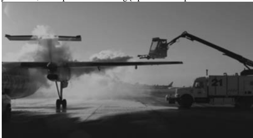
Rys. 5. Odladzanie samolotu na płaszczyźnie lotniska. [11]
