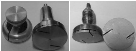
Rys. 4. Styk unipolarny (UNIS2) z nacięciami skośnymi
