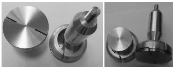
Rys. 3. Styk unipolarny (2P) z nacięciami promieniowymi
