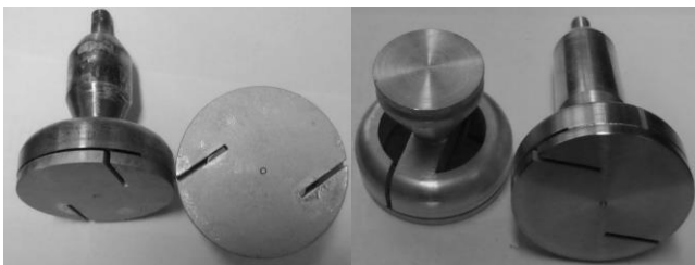
Rys. 10. Styki unipolarne (2S) po badaniach zwarciovych
