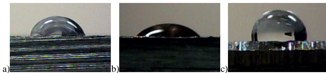
Rys. 2 Zdjęcia przykładowej kropli na powierzchni próbki stali X2CrNi18-9: a) po moczeniu 7 dni w płynie do dezynfekcji (kropla wody), b) po moczeniu 14 dni w roztworze Sterofundin ISO (kropla diiodometanu), c) po moczeniu 21 dni w roztworze 0,9% NaCl (kropla gliceryny)
