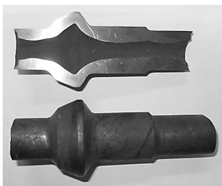
Rys. 8. Odkuwka wału wirnika głównego śmigłowca (ze stali w gatunku C45 oraz w skali 1:2), wykonana metodą obciskania obrotowego w agregacie pokazanym na rys. 7
