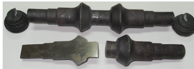
Rys. 4. Wałki stopniowane (ze stali C45) odwalcowane w układzie podwójnym w hydraulicznej walcarki płaskoklinowej Fig. 4. Stepped shafts from steel C45 rolled in double configuration in hydraulic flat-wedge rolling mill
