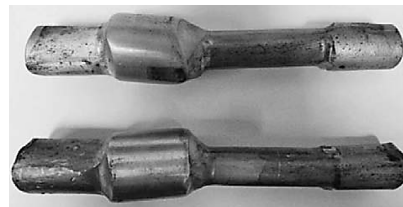
Rys. 10. Przedkuwki dźwigni ze stopu aluminium A2014 wykonane w walcierce ramowo-konsolowej Fig. 10. Preforms of lever from aluminium alloy A2014 made in frame-console rolling mill
