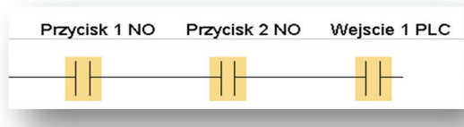
Rys. 11. Niepoprawny układ szeregowy przycisków (Logo Soft Comfort) Fig. 11. Incorrect layout of the buttons in series (Logo Soft Comfort)
