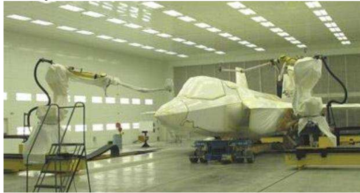
Rys. 8. Zautomatyzowany proces lakierniczy zastosowany na samolocie F-35 [6]
