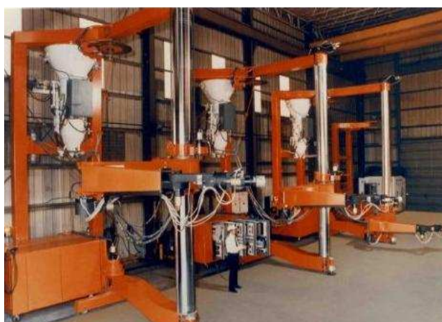
Rys. 5. Zautomatyzowany system usuwający powłokę lakierniczą w Robins Air Force Base. [5]
