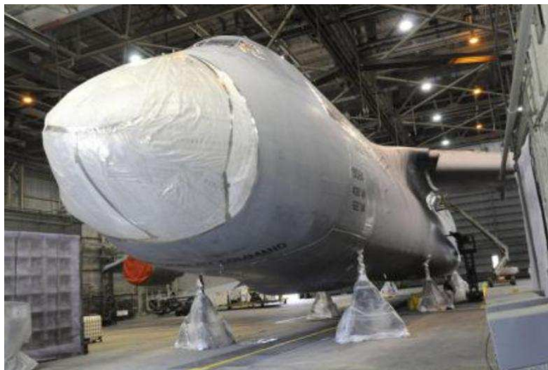
Rys. 7. Samolot C-130 Hercules podczas procesu usuwania lakieru. [6]
