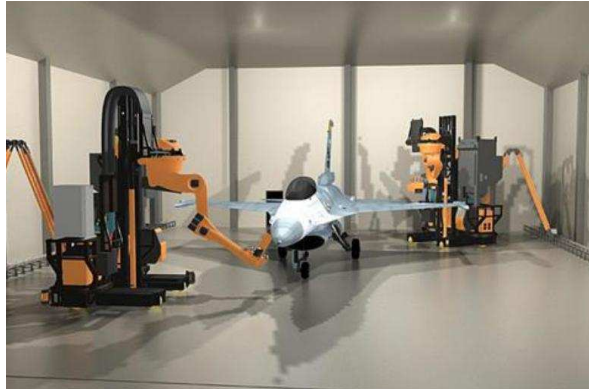
Rys. 1. Usuwanie farby z powierzchni samolotu F-16 przez zautomatyzowany system czyszczący. [3]
