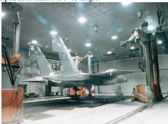
Rys. 4. Samolot F-15 Eagle podczas usuwania powłoki malarskiej przez system RDS. [5]
