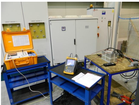
Rys. 6. Zdjęcie stanowiska pomiarowego z badanym transformatorem 30 kVA, 10 kHz
