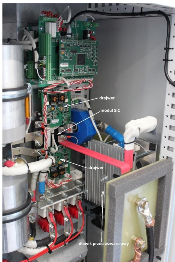
Rys. 2. Zdjęcie fragmentu stanowiska obejmujące 1-fazowy falownik wraz z elementami sterującymi i zabezpieczającymi
