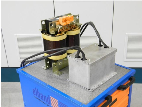
Rys. 5. Zdjęcie porównujące gabaryty transformatora 1-fazowego: klasycznego 5 kVA, 50 Hz (po lewej) i 30 kVA, 10 kHz (po prawej)
