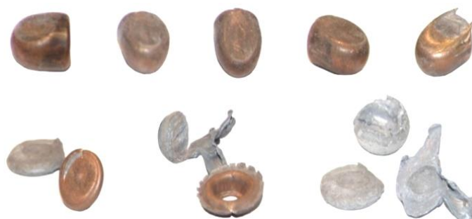
Fot. 4. Pociski 9x18 mm naboju Makarow, po zrykoszetowaniu na stalowej przegrodzie [1]
