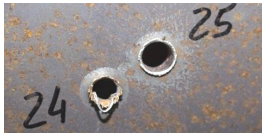
Fot. 3. Skutki uderzenia w blachę marki St3S o grubości 8 mm pocisku zwykłego 7,62x51 mm naboju bojowego (śląd nr 24) oraz pocisku 7,62x51 mm naboju ćwiczebnego (śląd nr 25) [4]
