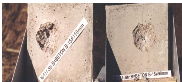
Fot. 2. Widok lejów wylotowych na próbkach badawczych wykonanych z betonu klasy B-15 [4]
