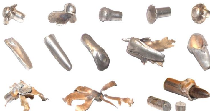
Fot. 5. Elementy pocisków zwykłych ŁPS (nabój 7,62x54R mm) i PS (nabój 7,62x39 mm) uszkodzone podczas rykoszetowania na stalowej przegrodzie oraz pocisk przeciwpancerno-zapalający B-32 i jego rdzeń pęknięty przy rykoszetowaniu (na dole po prawej) [1]
