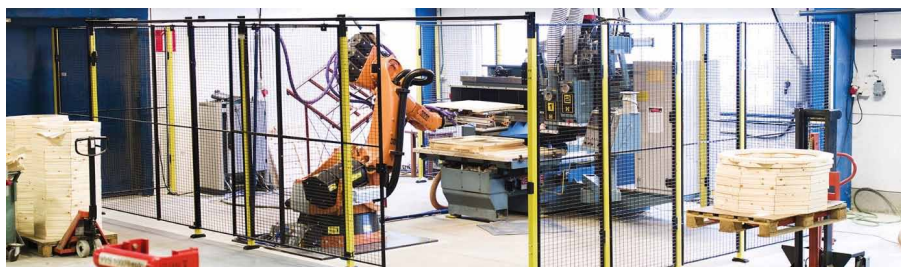
Rys. 1. Przykładowe ogrodzenie ochronne linii technologicznej
