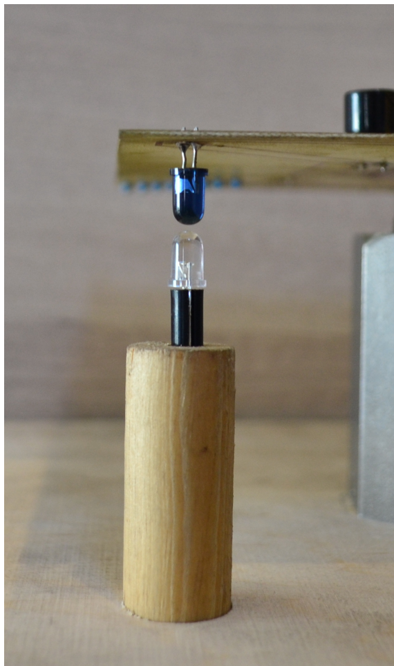
Rys. 3. Fotografia detektora położenia tarczy
