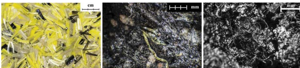
Fot. 1. (a) Widok luźnych włókien (strona lewa), (b) włókna w mma mieszanej w laboratorium (środek), (c) włókna w mma mieszanej w wytwórni (strona prawa), (fot. Ł. Mejlun)
