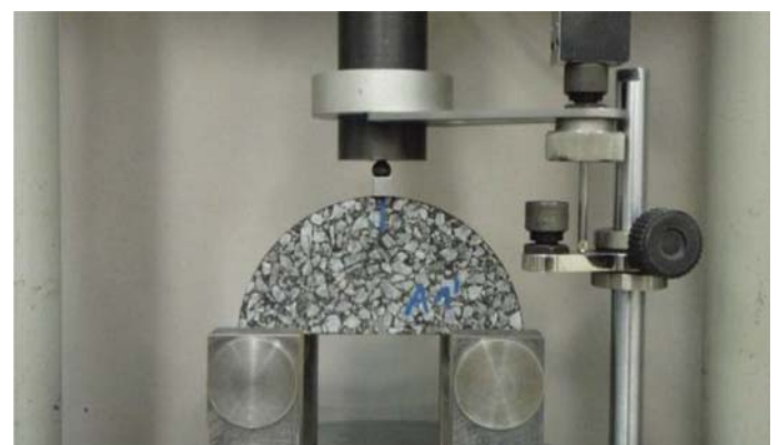
Fot. 2. Widok próbek podczas badania zginania w niskiej temperaturze: (a) próbka belkowa, (b) próbka półwałcowa
