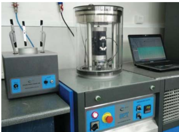
Fot. 3. Widok próbki podczas badania modułu dynamicznego
