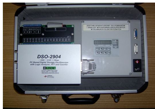
Rys. 5.1.1. Przenośny zestaw aparaturowy do pomiarów wnz silników [24, 25]
