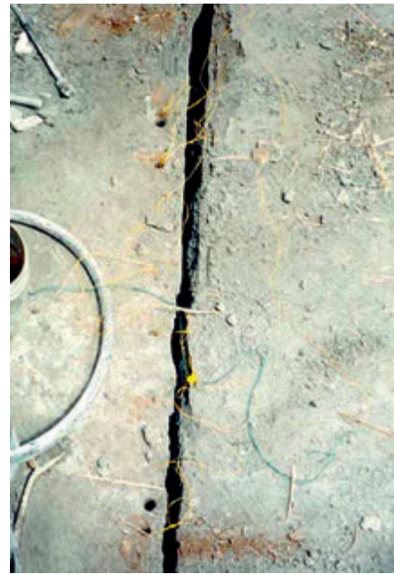
Fot. 4. Monolit odspojony od masywu skalnego Fot. 4. Block of natural stone separated from rock mass
