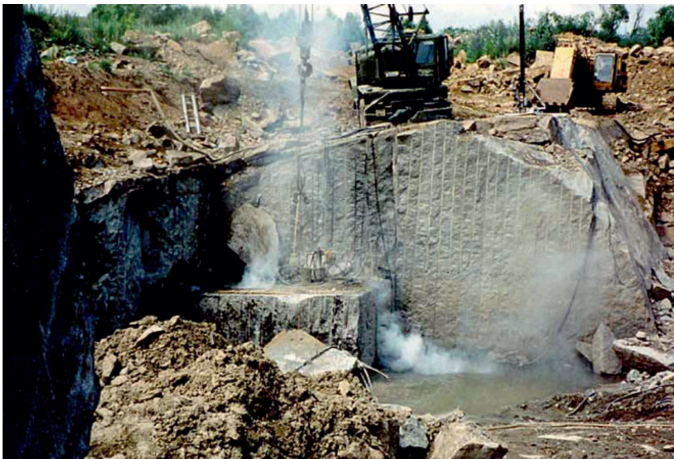
Fot. 5. Moment odspajania monolitu od calizny przy użyciu gazogeneratora Fot. 5. Moment of block separation from rock mass using gasgenerator
