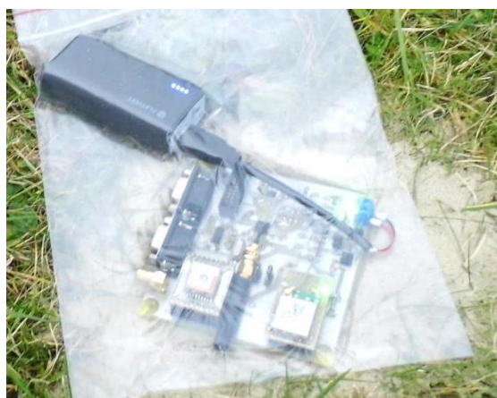
Fot. 2 Widok detektora sygnału uderzenia (po lewej stronie) oraz jego umocowanie w punkcie pomiarowym (po prawej)
