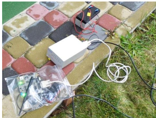
Fot. 3. Widok (po lewej stronie) kontroli pracy detektorów przez podgląd wysyłanych rekordów, obok koncentratora danych z nadajnikiem do stacji kierowania
