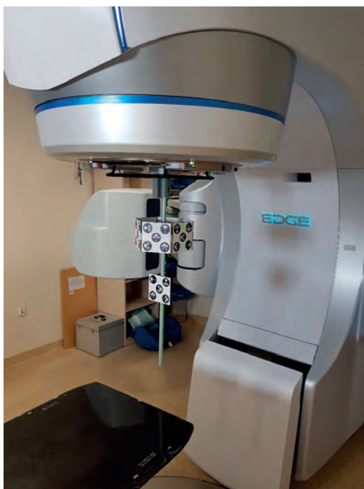
Ryc. 3 Markery przymocowane do głowicy przyspieszacza Źródło: Archiwum własne.
