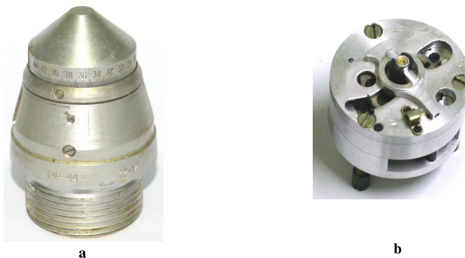
Fot. 3. Zapalnik TMR-44 i jego mechaniczny układ opóźniający z podziałką czasową na korpusie zapalnika: a – zapalnik TMR-44, b – mechanizm zegarowy wypracowujący wymaganą zwłokę działania.
