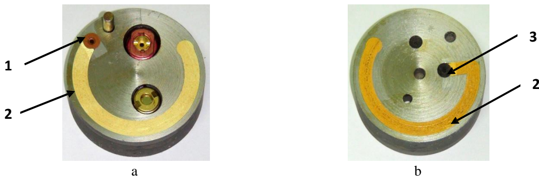
Fot. 6. Pirotechniczny układ opóźniający zapalnika AWKD-U:
