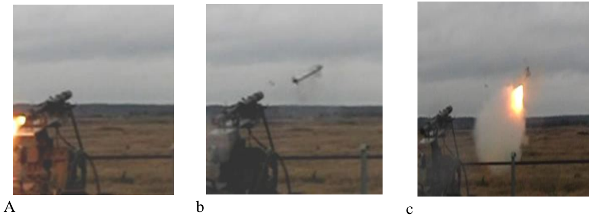
Fot. 1. Etapy odpalenia pocisku raketowego z wyrzutni: a – zadziałanie ładunku startowego, b – działanie układu opóźniającego, c – zadziałanie silnika marszowego
