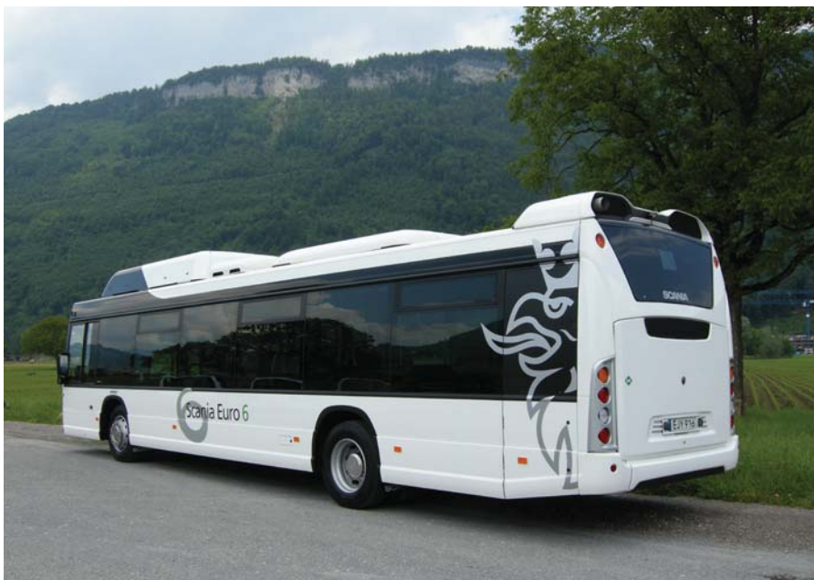
Umieszczenie silnika w wydzielonej „szafie” spowodowało zastąpienie tylnej szyby szklaną maskownicą połączoną z świetlikiem tablicy kierunkowej
