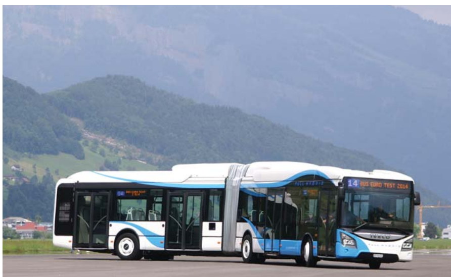
Iveco Urbanway 18 Full Hybrid z osłonami na dachu kryjącymi baterie oraz systemy sterowania mocą. Innym charakterystycznym elementem pojazdu były szklane ściany doświetlające wnętrze
