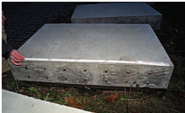
Rys. 4. Element badawczy. Płyta żelbetowa o wymiarach 80x120 cm zbrojona dwoma siatkami zbrojeniowymi
