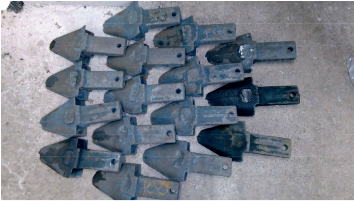
Fig. 5. The sample of tooth (tooth 2673) before cryogenic modification Rys. 5. Zęby przed modyfikacją kriogeniczną
