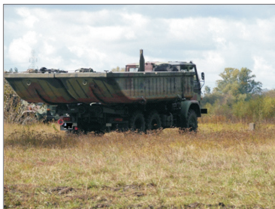
Rys. 2.2. Widok bloku pontonowego pływającego na samochodzie STAR 266 AP-64
