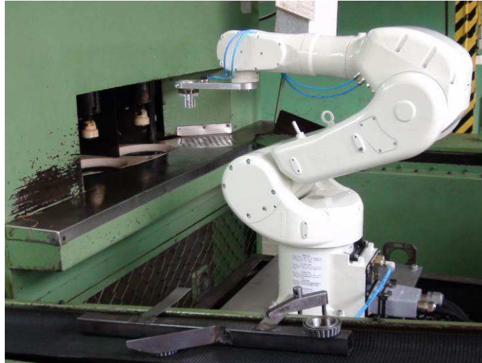
Rys. 12. Widok zrobotyzowanego gniazda technologicznego mycia złożeń łożyskowych.
