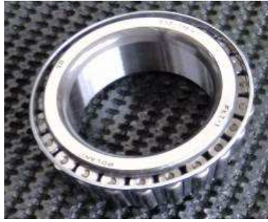
Rys. 2. Złożenie łożyskowe przeznaczone do mycia
