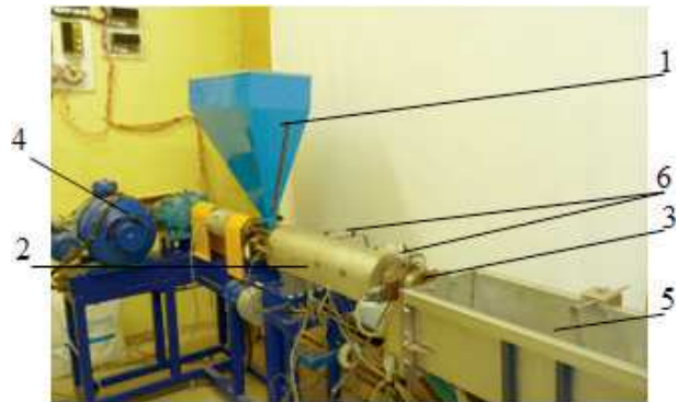
Rys. 2. Wygląd ogólny wytłaczarki W-25D wraz z głowicą wytłaczarską i urządzeniem ochładzającym (wanną chłodzącą): 1 – zasobnik tworzywa, 2 – układ uplastyczniający, 3 – głowica wytłaczarska, 4 – silnik napędowy, 5 – wanna chłodząca, 6 – czujniki pomiaru ciśnienia i temperatury tworzywa
