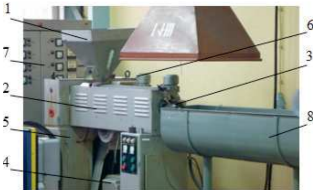
Rys. 1. Wygląd ogólny linii technologicznej wytłaczania konwencjonalnego T32-25: 1 – zasobnik tworzywa, 2 – układ uplastyczniający, wygląd obudowy, 3 – głowica wytłaczarska, 4 – silnik napędowy, 5 – obudowa przekładni redukcyjnych, 6 – wentylatory chłodzące, 7 – szafa sterownicza, 8 – urządzenie ochładzające
