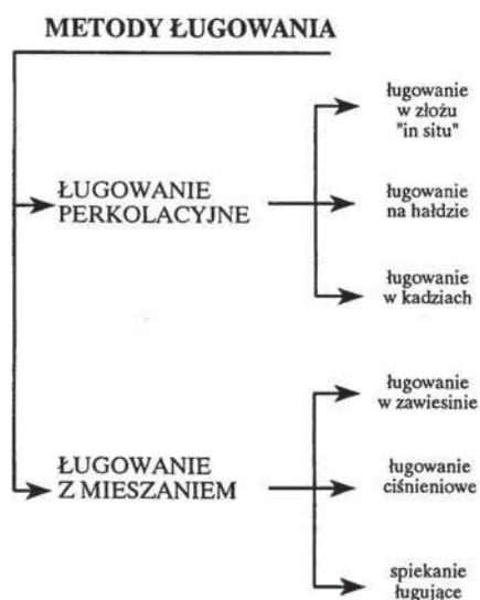
Rys. 11. Metody ługowania stosowane w technologiach hydrometalurgicznych [7]
