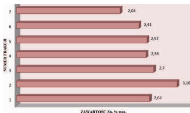
Rys. 3. Zawartość Zn w poszczególnych frakcjach szlamu konwertorowego
