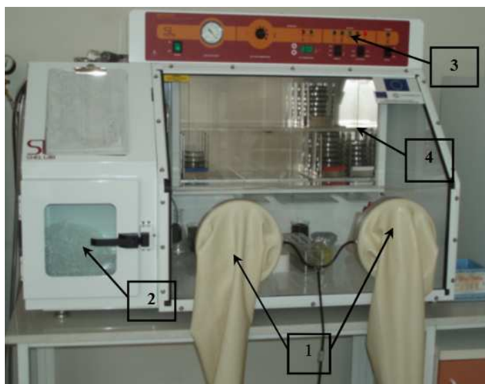
Rys. 1. Urządzenie BACTRON III-2: rękawy (1), śluza (2), sterownik (3), inkubator (4) Fig. 1. BACTRON III-2 station: manches (1), lock (2), controller (3), incubator (4)
