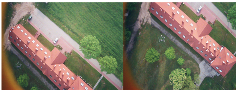
Rys. 4. Przykładowa, jedna z kilkudziesięciu par zdjęć niskopułapowych (w skali 1: 1500), realizowanych na terenie WIŚiG Akademii Rolniczej przy ul. Balickiej w Krakowie – opracowywane na VSD-AGH (wyniki zamieszczono poniżej) oraz FSC „Delta” (w realizacji).
