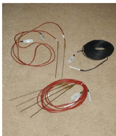
Rys. 11. Czujnik termometryczny kontaktowy (rys. 2. – nr 4) wraz z okablowaniem [10] (fot. archiwum autora)
