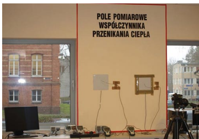
Rys. 7. Stanowisko laboratoryjne gotowe do pomiarów. Na ścianie zamocowane czujniki płytowe typu termopara. Zamocowane termometry kontaktowe. Statyw przygotowany do wykonywania fotografii wykonywanych w zakresie fal widzialnych oraz w zakresie widma fali podczerwieni (fot. archiwum autora)
