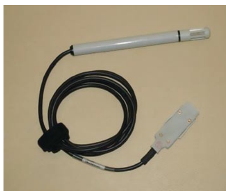
Rys. 13. Czujnik termiczno-wilgotnościowy [10] (fot. archiwum autora)
