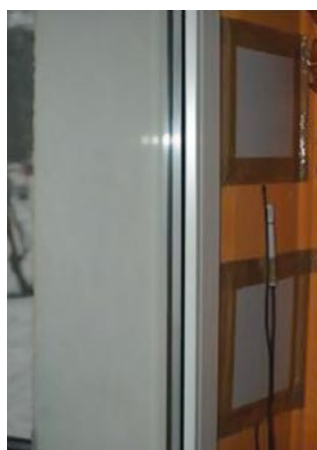
Rys. 8. Płytowe czujniki typu termopara zamocowane na ścianie osłonowej budynku mieszkalnego – OWT – 67 (fot. archiwum autora)
