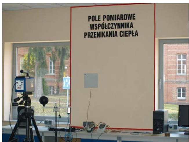
Rys. 6. Wstępne przygotowanie stanowiska do pomiarów współczynnika przenikania ciepła w warunkach in situ, na stole stanowiska pomiarowego widoczne rejestratory danych (na rysunku 2 – nr 5). Pomocniczo zainstalowana termowizyjna kamera laboratoryjna (fot. archiwum autora)
