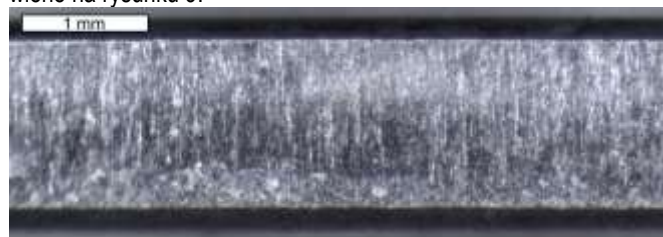
Rys. 9. Widok powierzchni pierwszego pierścienia uszczelniającego pracującego na eksploatowanym oleju, powiększenie 40x
