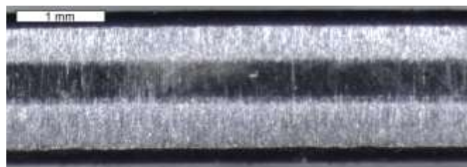
Rys. 8. Widok powierzchni pierwszego pierścienia uszczelniającego pracującego na nowym oleju, powiększenie 40x
