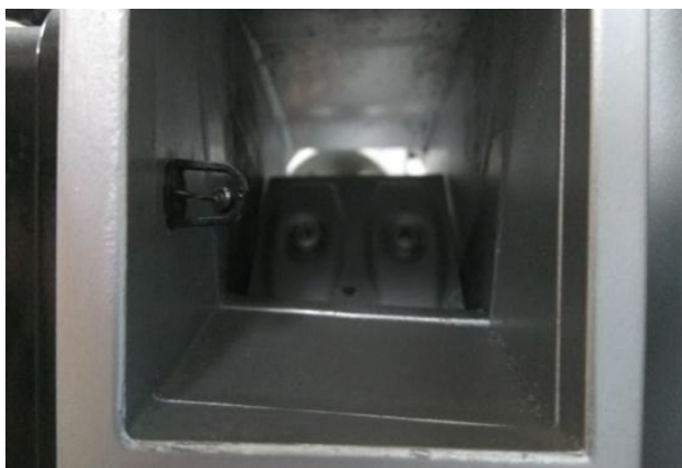
Rys. 2. Czujnik temperatury powietrza dolotowego wbudowany w przepływomierz
