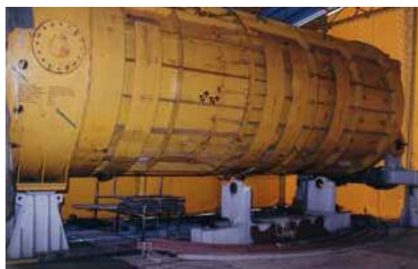
Fot. 3. Blok górny reaktora 1- bloku magazynowany w tymczasowym namiocie na placu budowy EJ „Zarnowiec” (fot. W. Kielbasa)
