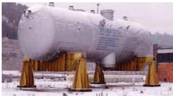
Fot. 6. Jedna z dwóch ze złomowanych wytwornic pary spośród czterech wytwornic dostarczonych na plac budowy EJ „Żarnowiec” (fot. W. Kielbasa)
