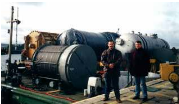
Fot. 5. Zbiornik, blok górny i urządzenia wewnątrz-zbiornikowe reaktora oraz wytwornica pary załadowane na ponton w Porcie Gdyńskim z przeznaczeniem dla EJ Loviisa w Finlandii (fot. Port Consultants)
